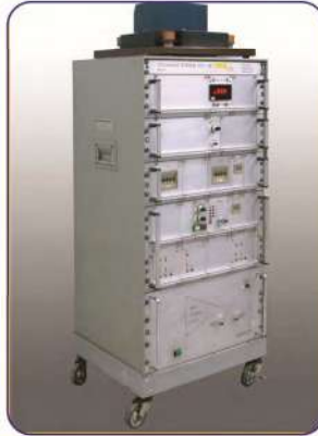
دستگاه اندازه گیری خواص مغناطیسی فولادهای الکتریکی (دستگاه تست ایشتنین)
